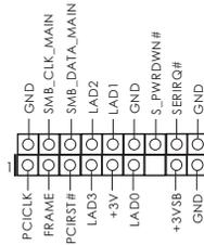
此接口支持 Trusted Platform Module (信任平台模块, TPM) 系统, 可以安全地存储密钥、数字证书、密码和数据。TPM 系统也可以帮助增强网络安全, 保护数字身份和确保平台完整性。
