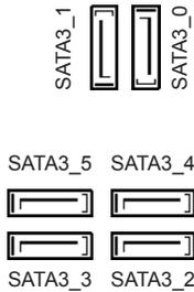
这六个 SATA3 接口支持最高 6.0 Gb/s 数据传输速率的内部存储设备的 SATA 数据线。如果 M2\_1 被 SATA 型 M.2 设备占用, SATA3\_0 和 SATA3\_1 的功能将被禁用。
