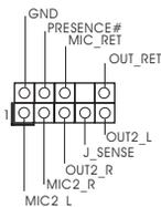
此接脚用于将音频设备连接到前音频面板。
