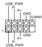
此主板上 有 2 个接脚。每个 USB 2.0 接脚可以支持两个端口。
